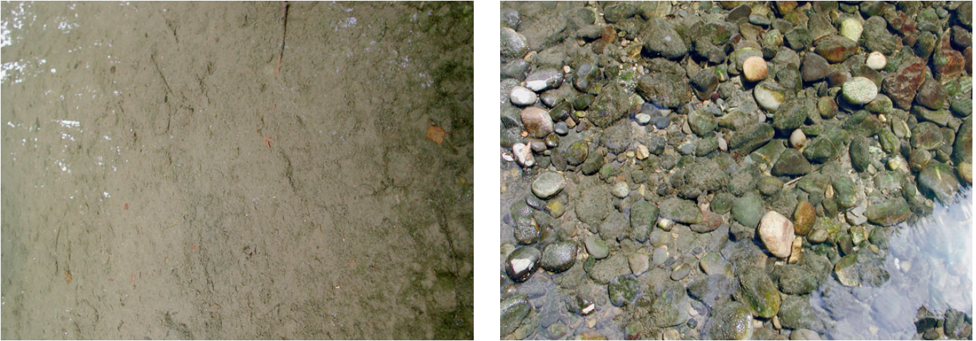
Abbildung 3.11: Gewässersohle unterhalb (links, kolmatiert) und oberhalb (rechts) einer Regenwassereinleitung (Davoli et al. 2003). (Fotos: Davoli)
