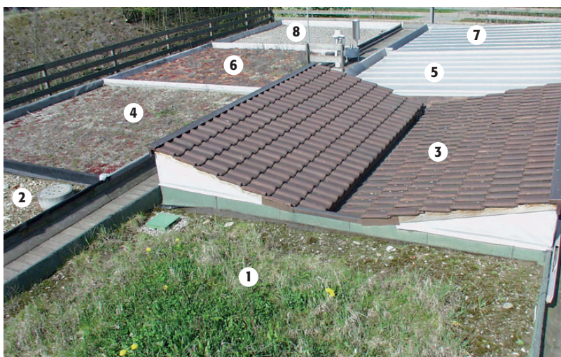
Figure 8: Installation d'expérimentation pour différents types de toitures à Burgdorf ( www.regenanalyse.ch ). Les numéros correspondent aux différents types de toitures. A droite, schéma de l'installation de mesure. (Photo: B. Gerber, HTA Burgdorf)
